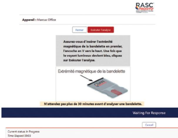
2. Connectez-vous au portail à l'adresse [www.csan.ca](http://www.csan.ca) en utilisant les informations de connexion fournies par RASC<sup>MD</sup>. Une fois que la bandelette d'analyse RASC<sup>MD</sup> Pronto<sup>MD</sup> est insérée correctement, le voyant lumineux à DEL du dispositif devient bleu. Choisissez l'identifiant du patient approprié et suivez les étapes de chaque écran. Une fois cette étape terminée, cliquez sur « Begin Test » (Exécuter l'analyse).
