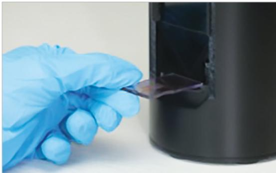
1. Placez la bandelette d'analyse RASC<sup>MD</sup> Pronto<sup>MD</sup> dans la base du dispositif RASC<sup>MD</sup> Pronto<sup>MD</sup> à l'intérieur du logement à glissière comme il est illustré **en insérant d'abord la bande magnétique (bord noir), et l'autocollant faisant face vers le haut.**
