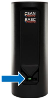
Le voyant lumineux du dispositif RASC<sup>MD</sup> Pronto<sup>MD</sup> permet de déterminer le statut du dispositif.
