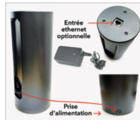
1. Branchez l'adaptateur d'alimentation dans la prise d'alimentation qui se trouve sur la partie arrière inférieure du dispositif (tel qu'illustré).
